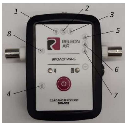
Рис. 2. Мультидатчик по экологии. Обозначение разъёмов и технологических отверстий: 1 — освещённость, 2 — относительная влажность воздуха, 3 — температура окружающей среды, 4 — температура растворов, 5 — нитрат-ионы, 6 — хлорид-ионы, 7 — pH, 8 — электропроводность
