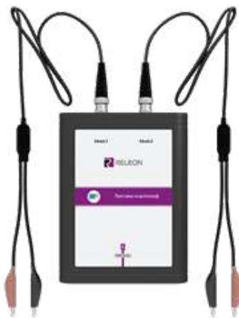
Рис. 1. Двухканальная приставка-осциллограф Releon
