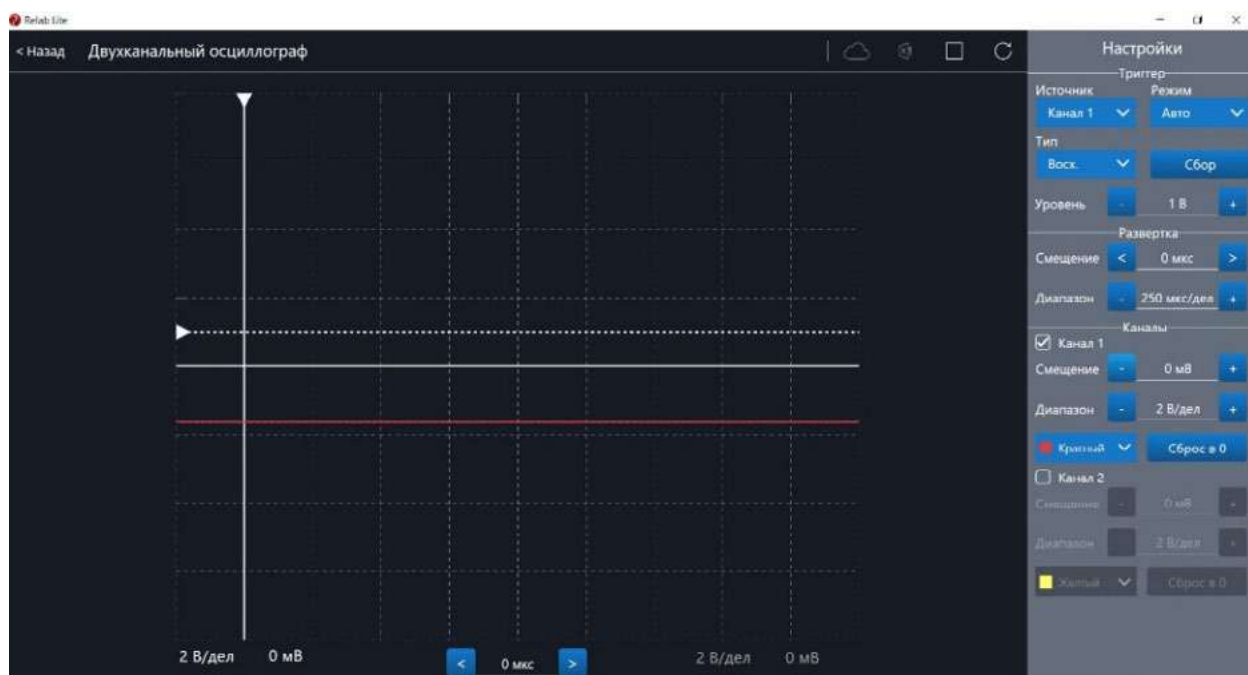
Рис. 40. Сигнал с ненулевым смещением
