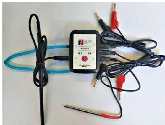
Рис. 9. Беспроводной мультидатчик Releon Air «Физика-5»
