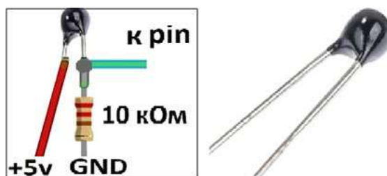
Рис. 3. Схема подключения к микроконтроллерной плате терморезистора
